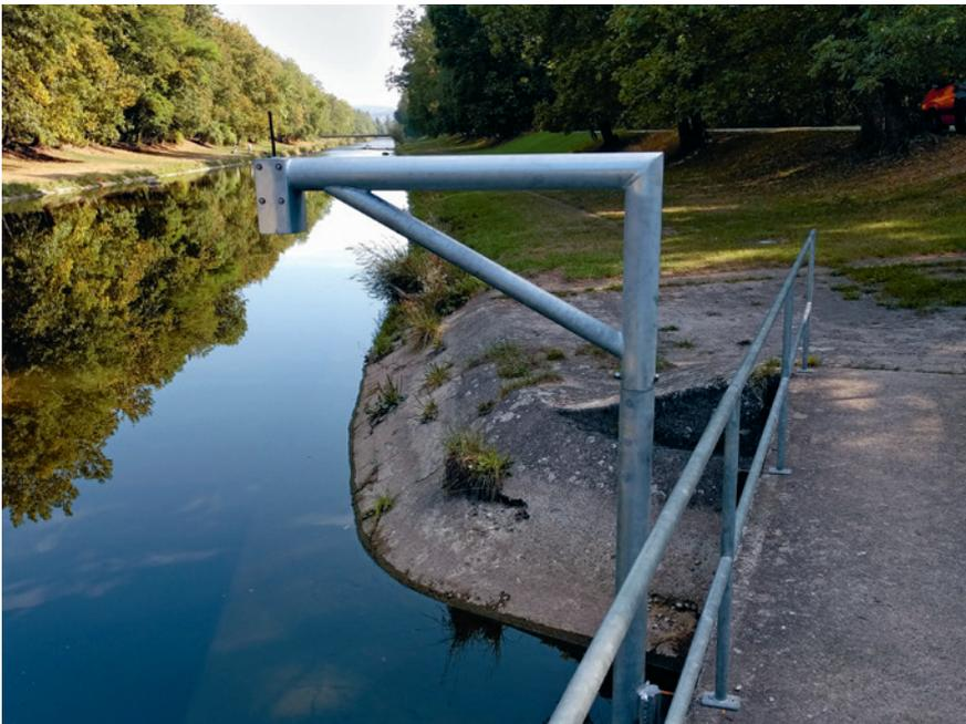
Einer der LoRa-Sensoren misst den Pegelstand der Wiese in den Langen Erlen.
